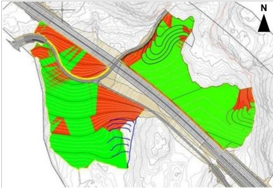
Figur 4-9: Viser masselager på nord- og sørsiden av planlagt E39 ved Flaten. Grønt viser terreng slakere enn 1:8 etter fylling av masser. Her er det mulighet for landbruk/ åkerdrift etter tiltaket (Kilde: Sweco Norge)
