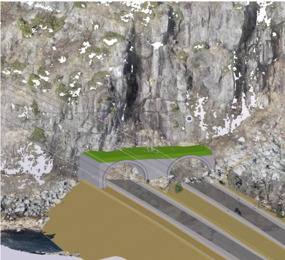
Figur 28: Utklipp fra modell som viser østlig påhuggsområde med prosjektert tunnel plassert omtrentlig som prosjektert.
