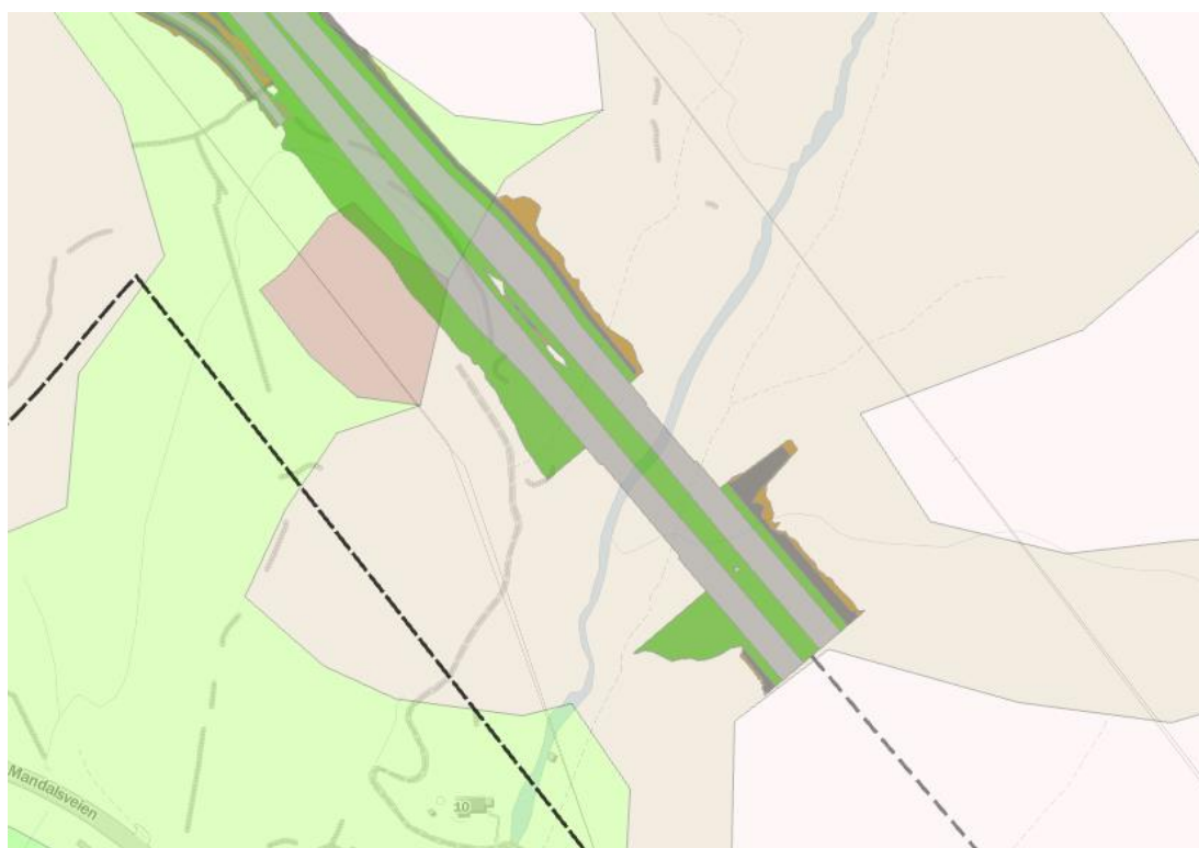
Figur 8: Fylling ved Lene – utsnitt fra innsynsportal som viser forventede grunnforhold samt veg med vegfyllinger
