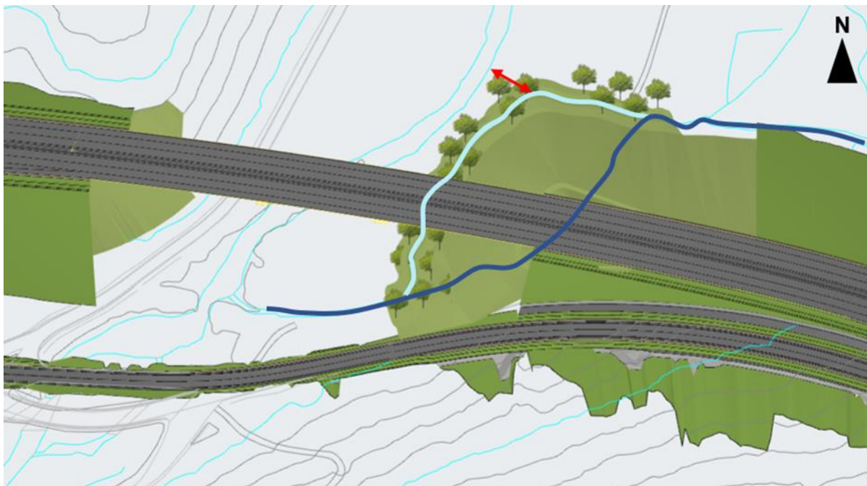
Figur 31 Viser dagens bekkeløp for Eikelandsbekken (mørk blå linje) Forslag til omlagt bekkeløp (lys blå linje) langs fyllingen under Optedal bru. Plassering av midlertidig bekkeløp under anleggsfasen er vist med rød pil. (Kilde: Sweco)
